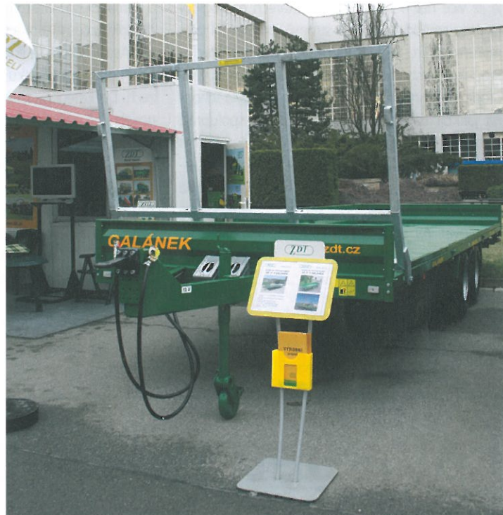
Návěs na přepravu balíků Galánek s nosností 11 tun pojme 22 balíků o průměru 1,2 m nebo 18 balíků o průměru 1,5 m
